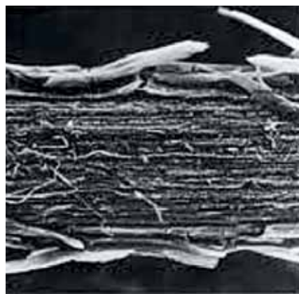
Коррозия проволоки медной оплётки внутриматочного устройства, находившегося в полости матки 202 дня (Kosonen A. Corrosion of copper in utero // Fertil. Steril. 1978. Vol. 30 (1). P. 59–65. PMID: 680184).
